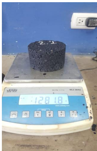
Ilustración IV-21: a) Pesos al aire, b) Peso sumergido y c) Peso superficialmente seco, Laboratorio ASFISA.
