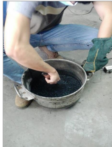
Ilustración IV-16: a) Mezclado automático de la mezcla asfáltica b) Mezclado manual del material, Laboratorio ASFISA.
