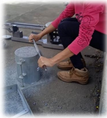
Ilustración II- 11: a) Enrasado del material grueso en el espécimen, b) Cálculo del peso del agregado + espécimen. Laboratorios RURMA.
