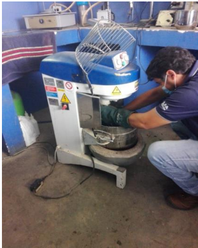
Ilustración IV-16: a) Mezclado automático de la mezcla asfáltica b) Mezclado manual del material, Laboratorio ASFISA.
