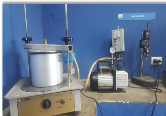
Ilustración IV-24: a) Control de la temperatura previo al Ensayo Rice, b) Colocación del material en el equipo, c) Enrasado del material + agua para obtener su peso. Laboratorio ASFISA.
