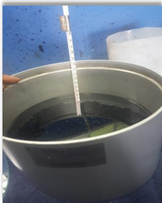
Ilustración IV-24: a) Control de la temperatura previo al Ensayo Rice, b) Colocación del material en el equipo, c) Enrasado del material + agua para obtener su peso. Laboratorio ASFISA.
