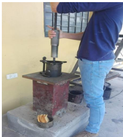
Ilustración IV-19: a) Fabricación de las briquetas, b) Resultados de las briquetas. Laboratorio ASFISA.
