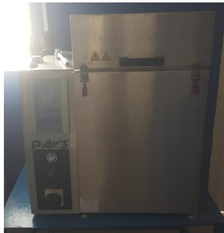
Ilustración II- 6: Equipo PAV-3 para ensayo de envejecimiento acelerado, Laboratorios ASFISA.
