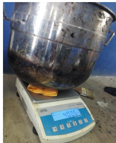
Ilustración IV-15: a) Obteniendo cantidad de asfalto para mezcla., b) Determinación del Peso del agregado + asfalto. Laboratorio ASFISA.
