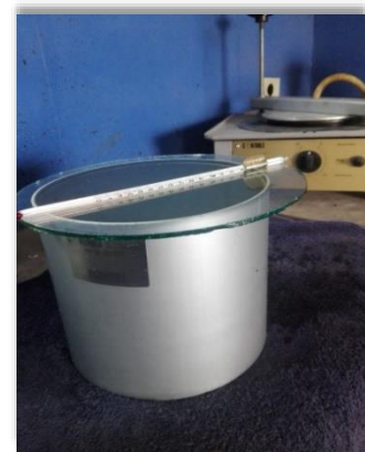
Ilustración IV-24: a) Control de la temperatura previo al Ensayo Rice, b) Colocación del material en el equipo, c) Enrasado del material + agua para obtener su peso. Laboratorio ASFISA.
