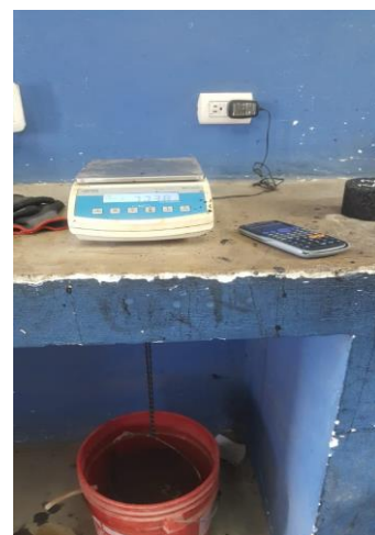
Ilustración IV-21: a) Pesos al aire, b) Peso sumergido y c) Peso superficialmente seco, Laboratorio ASFISA.
