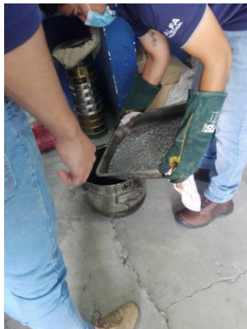
Ilustración IV-15: a) Obteniendo cantidad de asfalto para mezcla., b) Determinación del Peso del agregado + asfalto. Laboratorio ASFISA.
