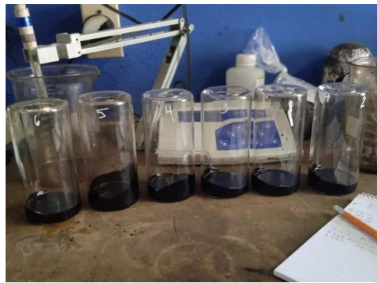
Ilustración IV-12: Muestras de los ligantes modificadas para prueba RTFO.
