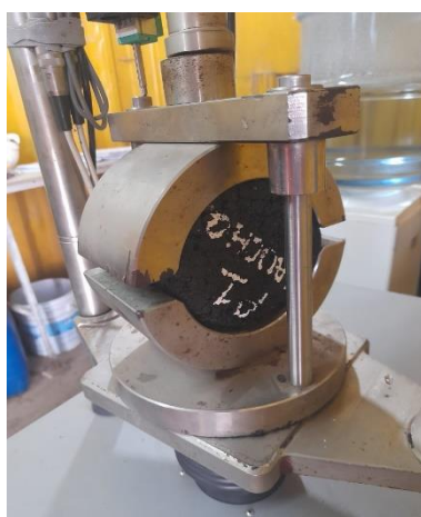
Ilustración IV-23: a) Briqueta colocada en Equipo Marshall b) Grafica resultante de Ensayo Marshall, Laboratorio ASFISA. Fuente: Propia
