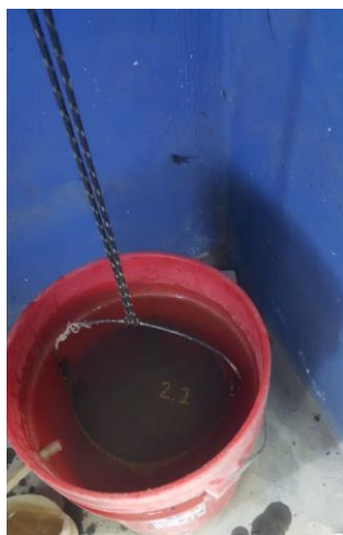
Ilustración IV-21: a) Pesos al aire, b) Peso sumergido y c) Peso superficialmente seco, Laboratorio ASFISA.
