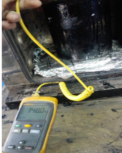
Ilustración IV-14: Determinación de la temperatura del asfalto, Laboratorio ASFISA.
