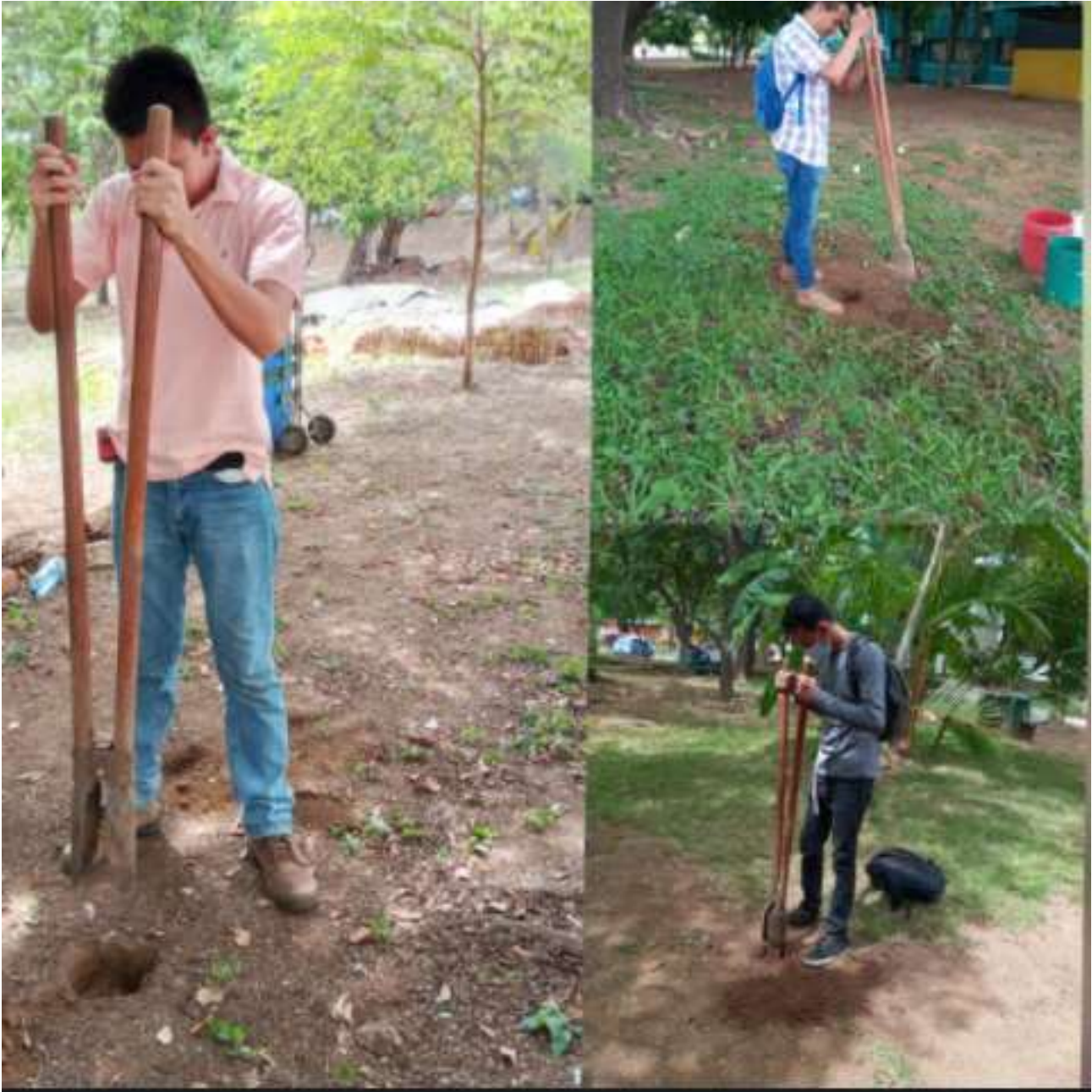
Anexo 15. Ensayo de infiltración por el método de Porchet
