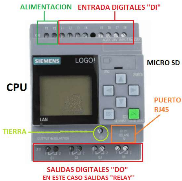
Figura 6 Imagen PLC logo 8 (fuente Electrical, chile)
