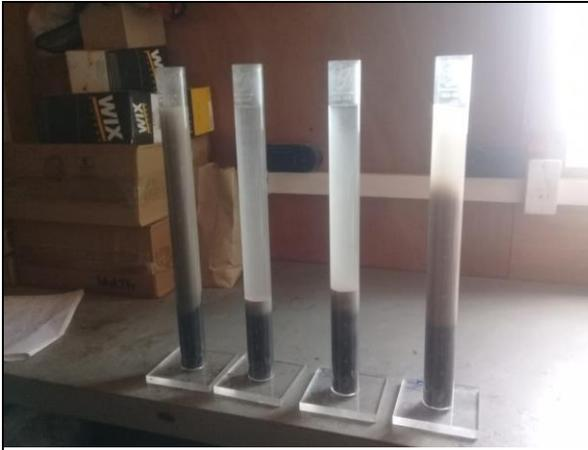
Probetas con Material Fino triturado, ensayo Equivalente de Arena
