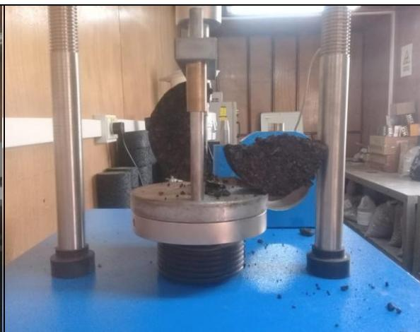
Ensayo de Tensión Diametral
