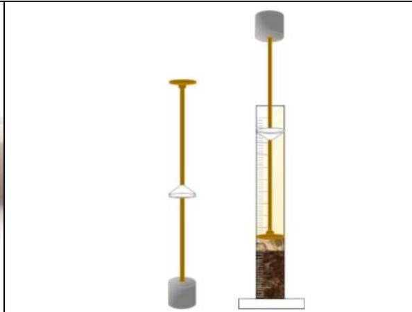
Probeta y Pisón lastrado, ensayo Equivalente de Arena.
