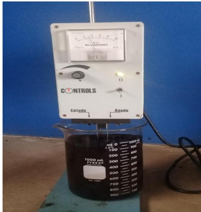
Figura 4. Ensayo de carga de partículas. Fuente: Propia.
