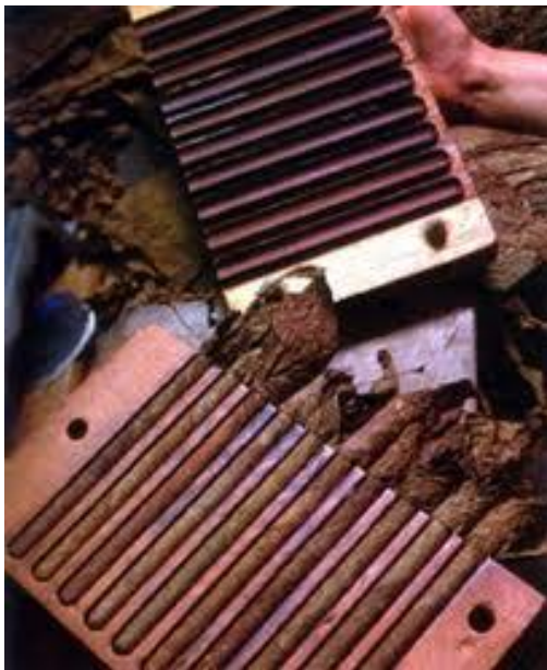
Colocación en moldes de madera
