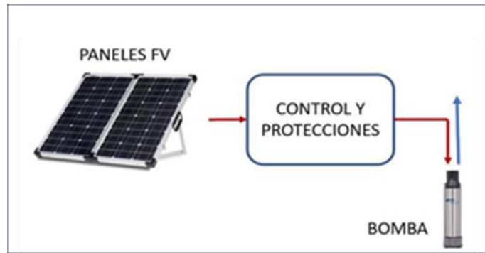
Figura 15. Esquema de bombeo directo.
