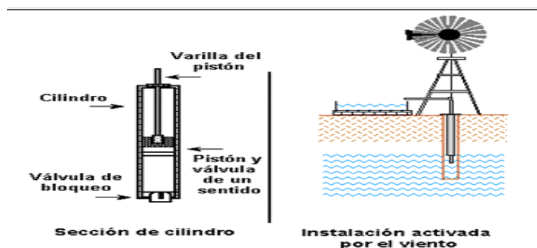
Figura 18. Esquema de una bomba volumétrica de cilindro
