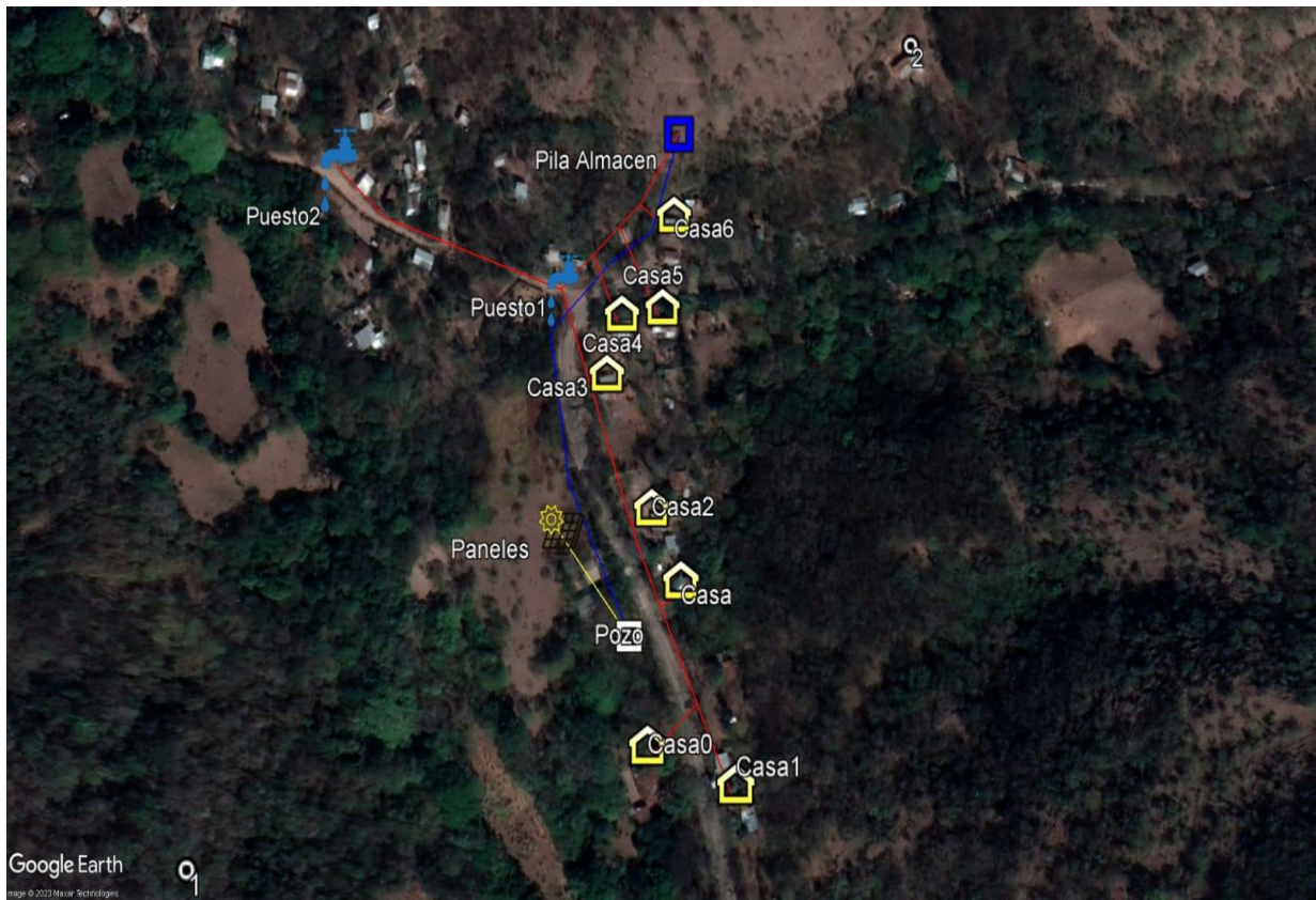
Figura 42. Esquema de mini acueducto del SBSFV
