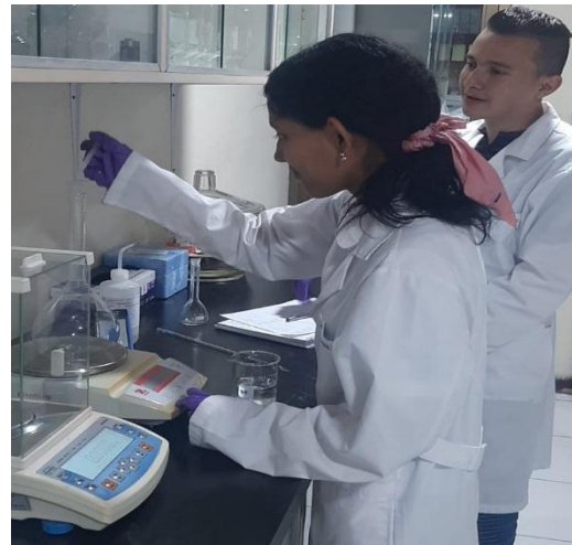
Verificación del matraz de 1,000 mL
