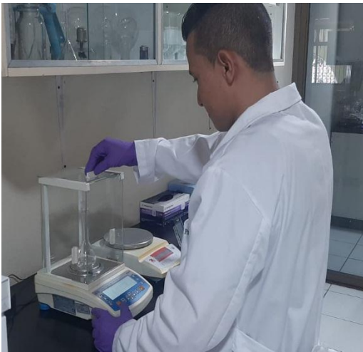
Verificación del matraz de 100 mL
