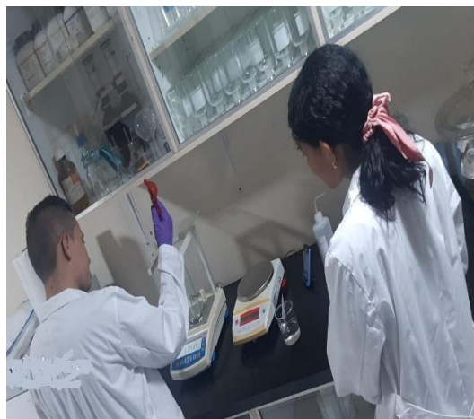
Verificación de la pipeta graduada 5 mL
