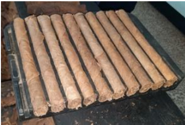
Ilustración 19. Puro en los moldes
