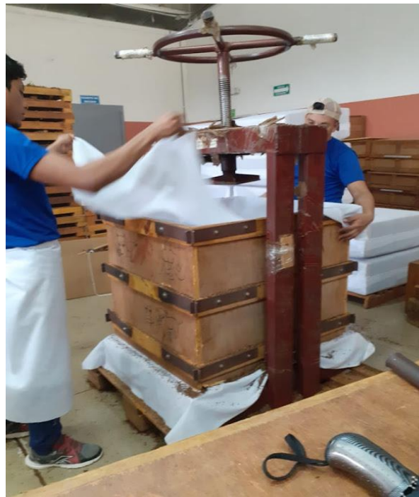
Imagen 8: Proceso de compresión de paca
