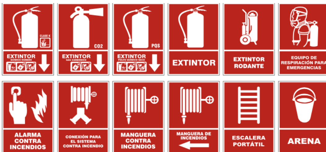
Figura 3.8. señales contra incendio
