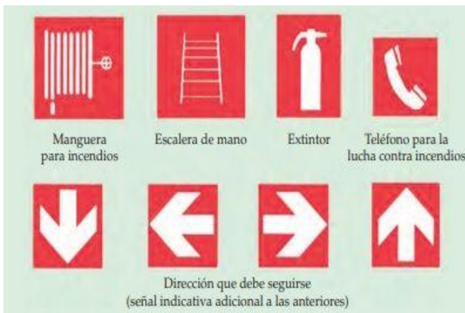
Figura 3.4. Señales contra incendios
