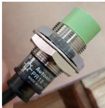
Sensor inductivo instalado.
