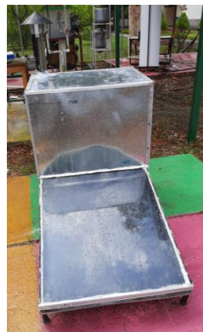
Figura 2. deshidratador solar construido
