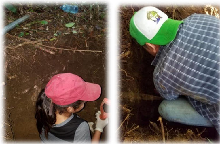
Figura 3. Realización de calicatas, parte alta
