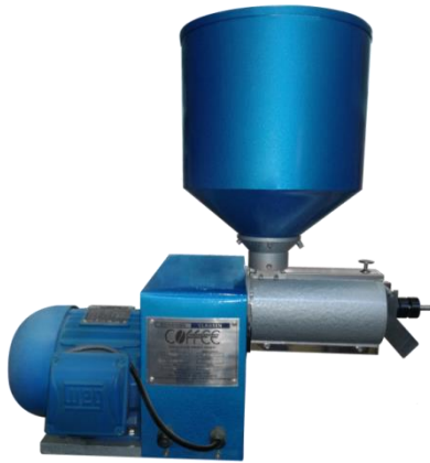
Ilustración 5. Trilladora k 60 extraído del autor péganos clasuen.
