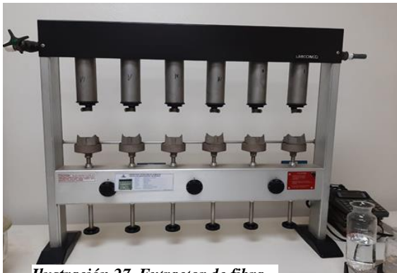
Ilustración 27. Extractor de fibra.
