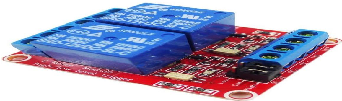
Este módulo relé de dos canales dispone de opto acopladores. Posee 3 terminales VCC, GND, y la entrada de señal de estado lógico, el módulo puede ser accionado por una board Arduino,
