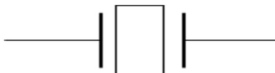
Cuando sometemos al oscilador de cristal a una determinada tensión el material del oscilador (normalmente un material piezoeléctrico como el cuarzo) produce una corriente con una frecuencia determinada y precisa (INFOOTEC.NET, 2022).
