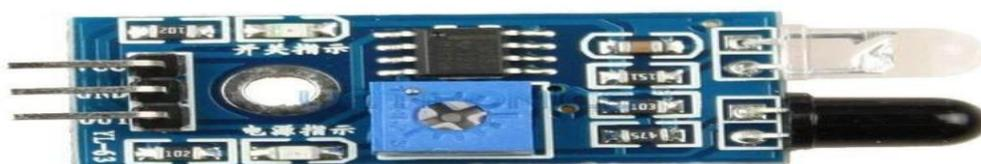
Los detectores de obstáculos suelen estar equipados con una placa de medición estándar con un comparador LM393. Cuando se excede un cierto umbral, la placa de medición puede obtener una lectura de un valor digital. El umbral se ajusta mediante un potenciómetro en la placa (Rslicing3D, 2021).
