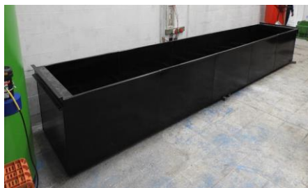
Foto 15 - Tanque de enfriamiento
