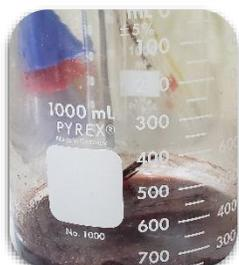
Se colocó la muestra en un beaker de 1000 ml y luego se ubicó en una estufa eléctrica
