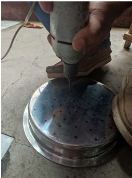
Figura 7 Elaboración de la placa de extrusión para el peletizado del pienso
