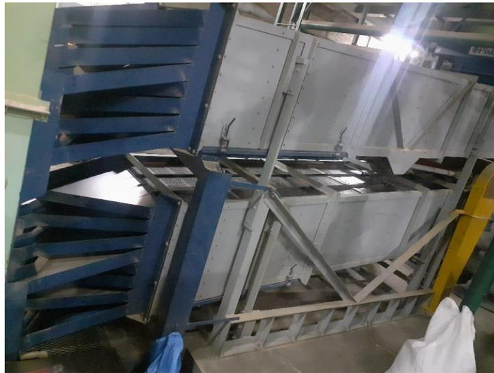
*Ilustración 17. Máquina clasificadora por tamaño del café*
