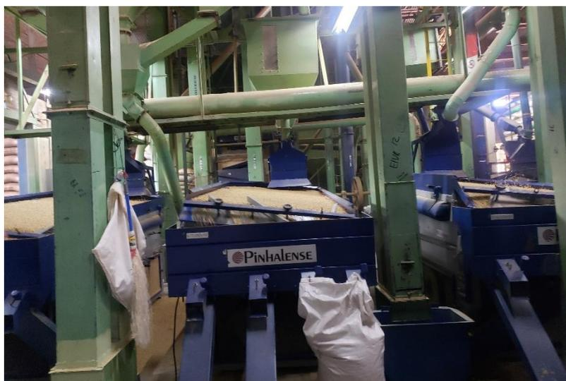
*Ilustración 18. Máquinas densimétricas de café oro*
