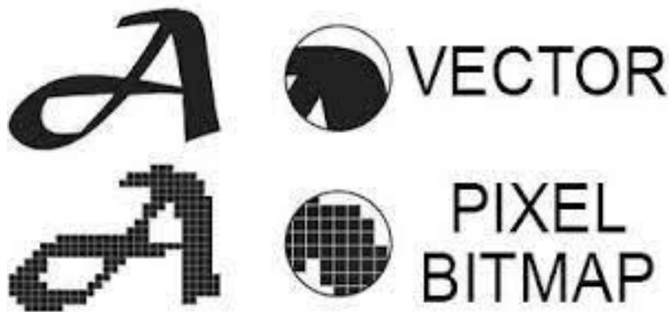
Ilustración 52. Ejemplo de imagen en vector y de una en bitmap
