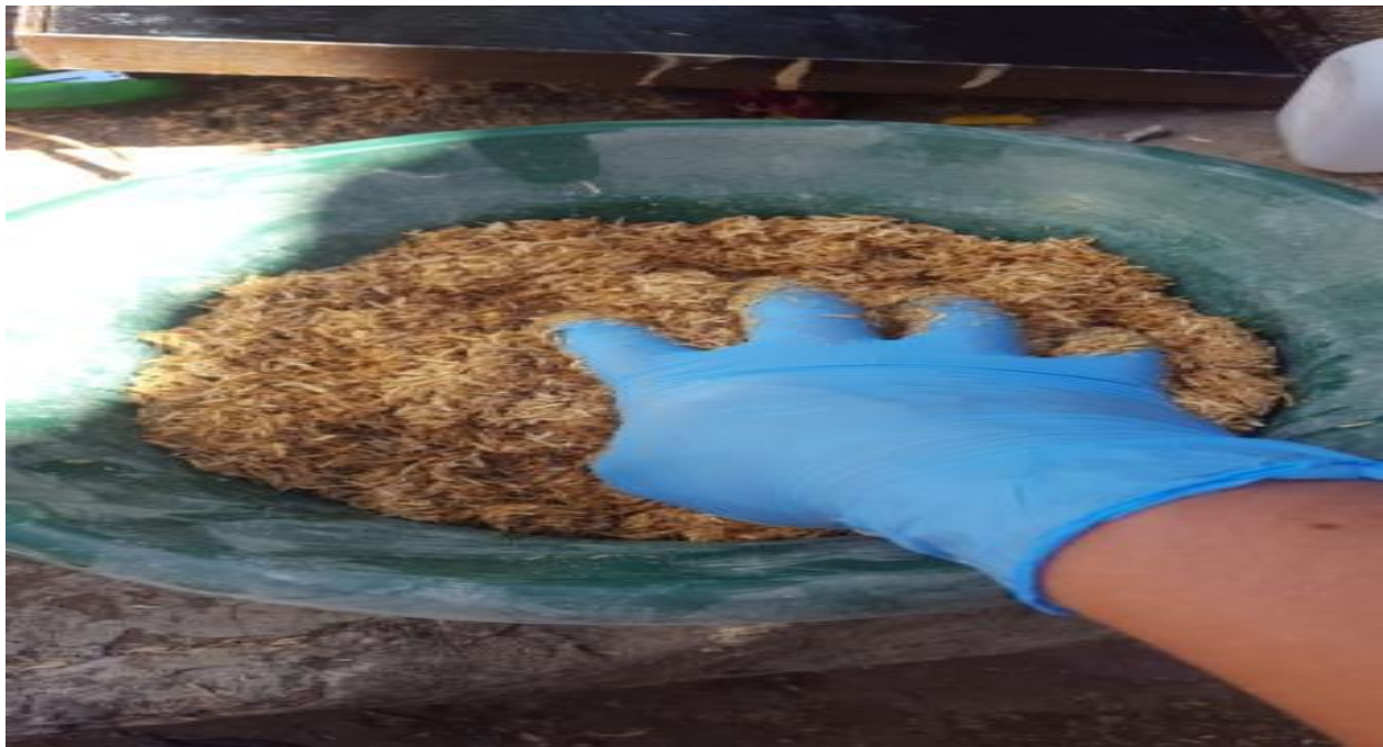
Figura 7. Mezcla de la cascarilla de arroz colocada en la prensa. Fuente: Elaboración Propia
