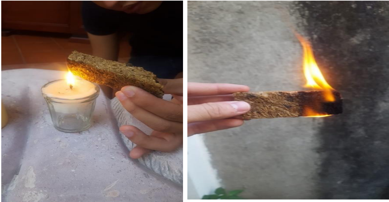
Figura 16. Test de la Llama a tablones
