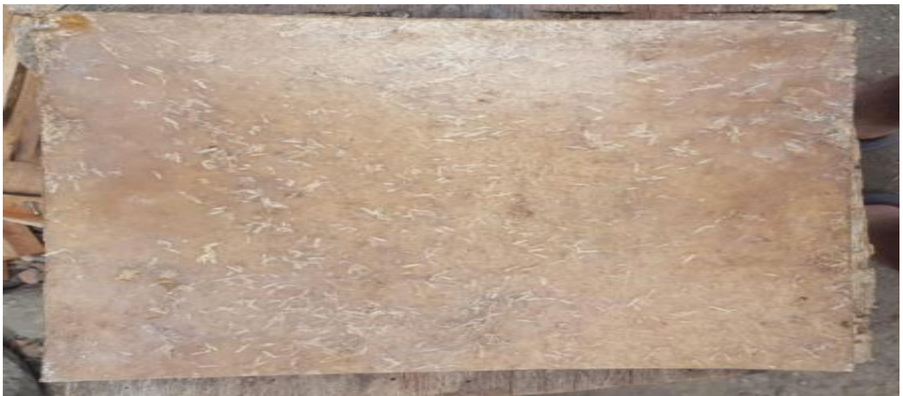
Figura 8. Aglomerados elaborados con los diferentes tipos de adhesivos. Fuente: Elaboración Propia
