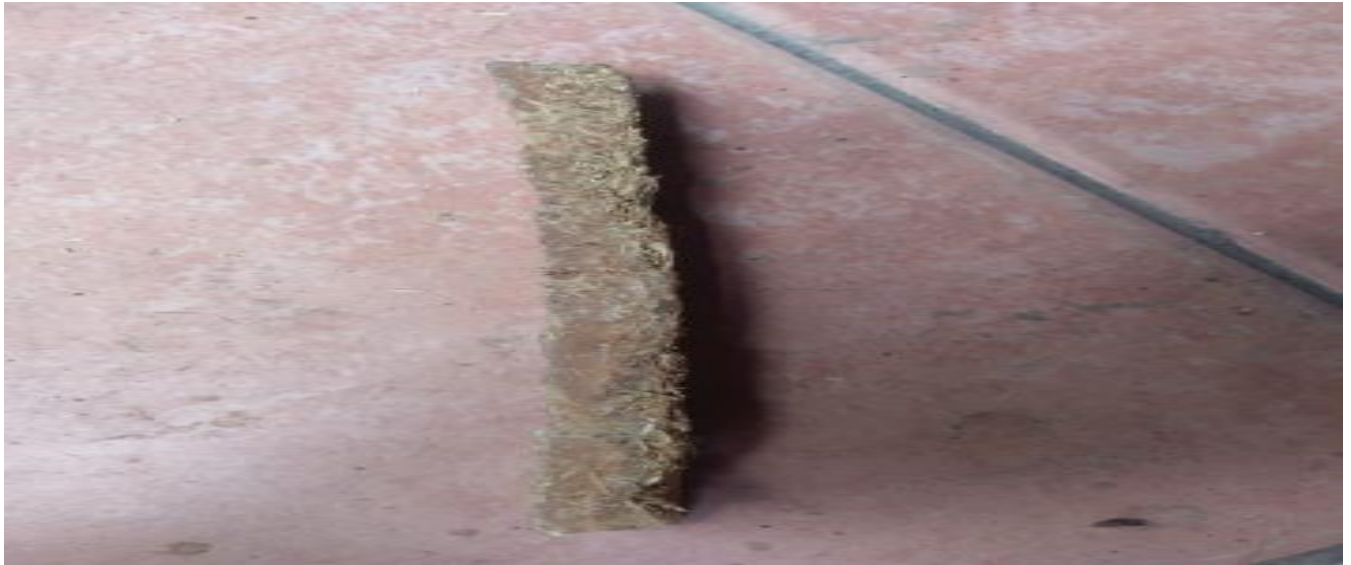
Figura 13. Muestra de aglomerado 50% cascarilla 50% resina Fuente: Elaboración Propia
