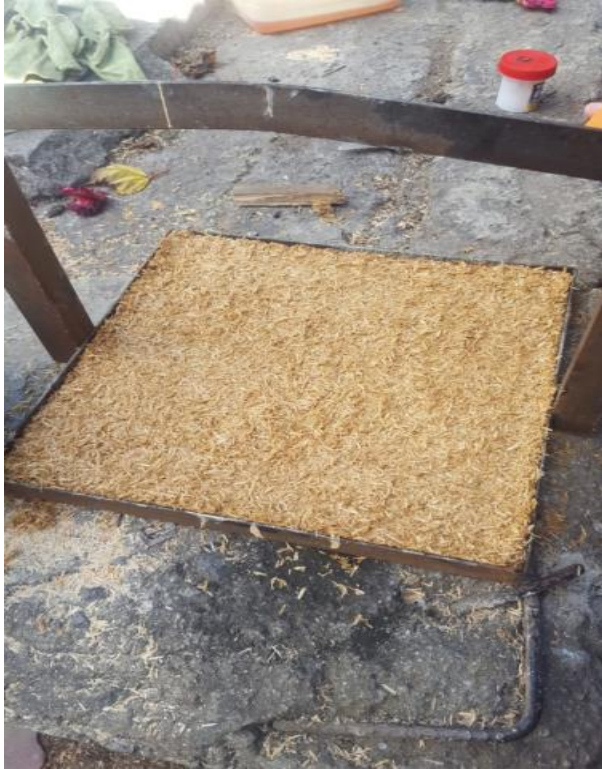
Figura 8. Aglomerados elaborados con los diferentes tipos de adhesivos. Fuente: Elaboración Propia
