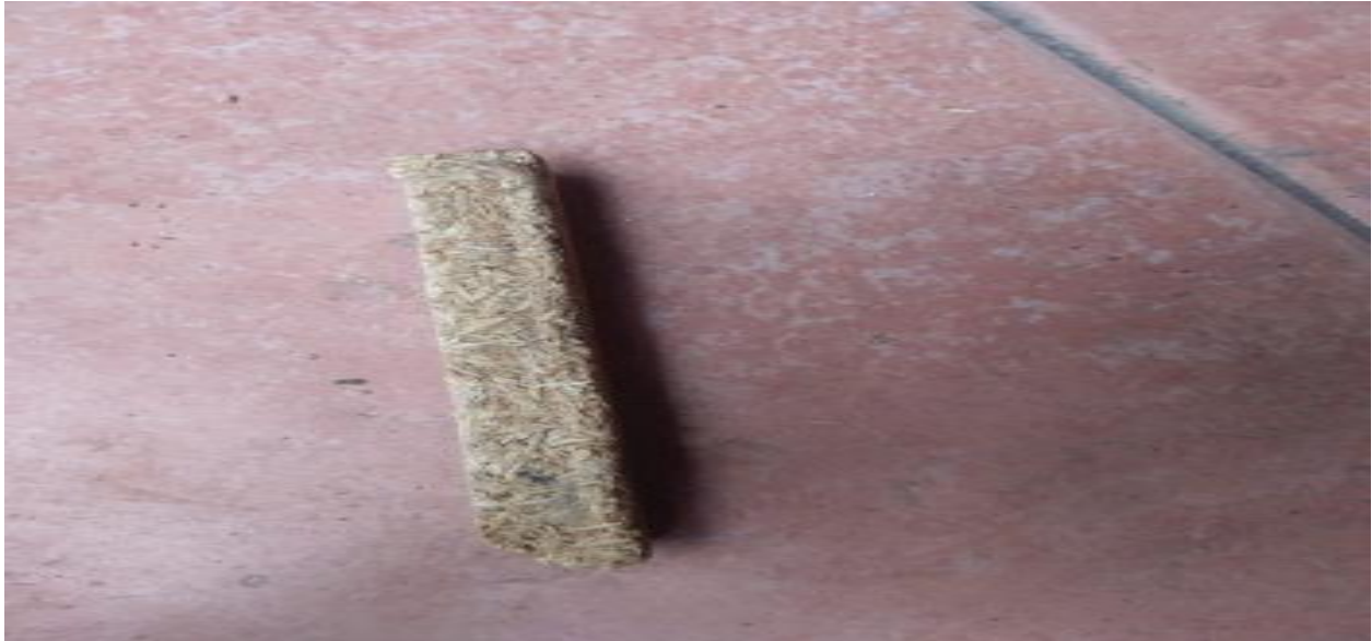
Figura 14. Aglomerado 50% cascarilla 40% cola Blanca 10% Resina Fuente: Elaboración Propia
