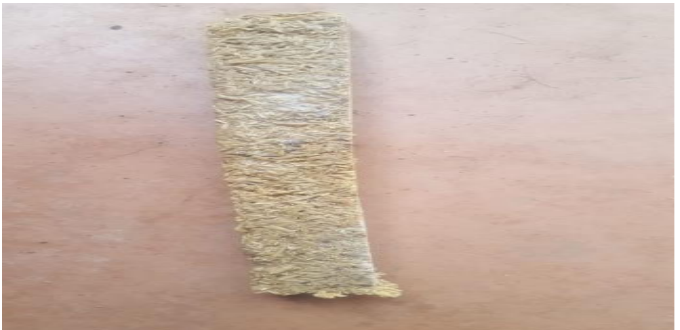
Figura 12. Muestra de aglomerado 50% cascarilla 50% cola blanca Fuente: Elaboración Propia
