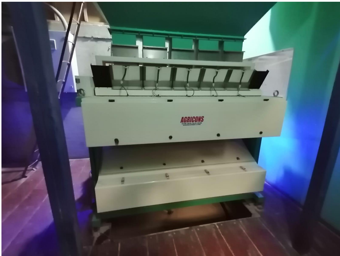
Ilustración 37 Clasificadora por color
