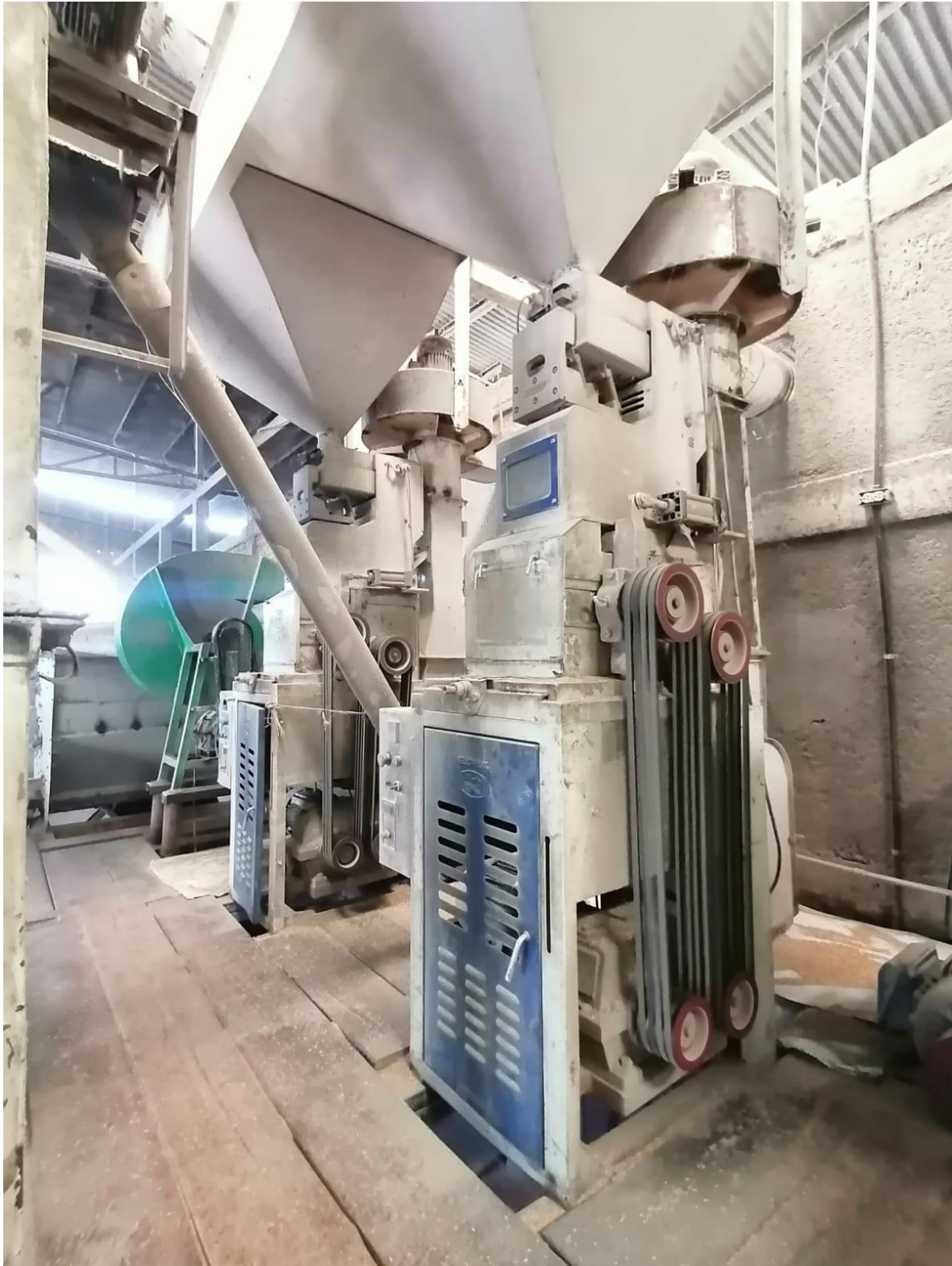
Ilustración 42 Descascaradora de arroz
