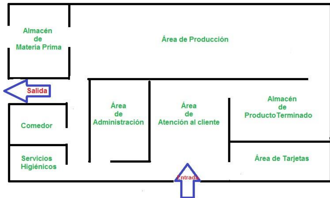
Figura N°18: Diseño de la planta. Fuente: elaboración propia.
