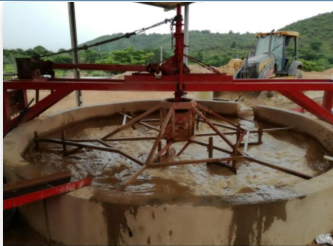
Deslamador o amalgamador, donde se forma la amalgama oro-mercurio.
