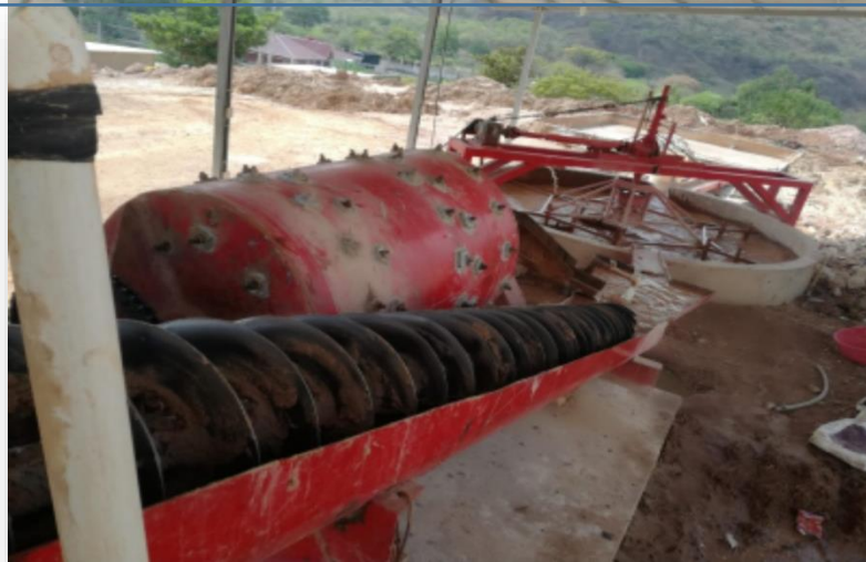
Fotografía del Molino de bolas, y su colcho de retorno, el cual es utilizado para la reducción de tamaño.
