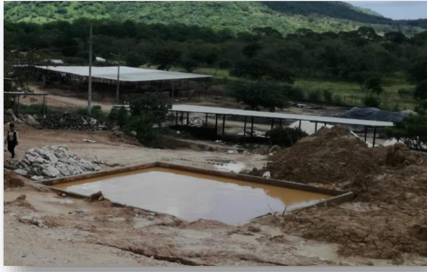
Fotografía de la pila de recolección de sedimentación de colas de amalgamación.
