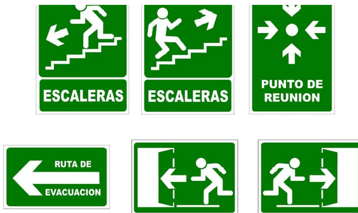
Ilustración 3 Señalización para salida de emergencia
