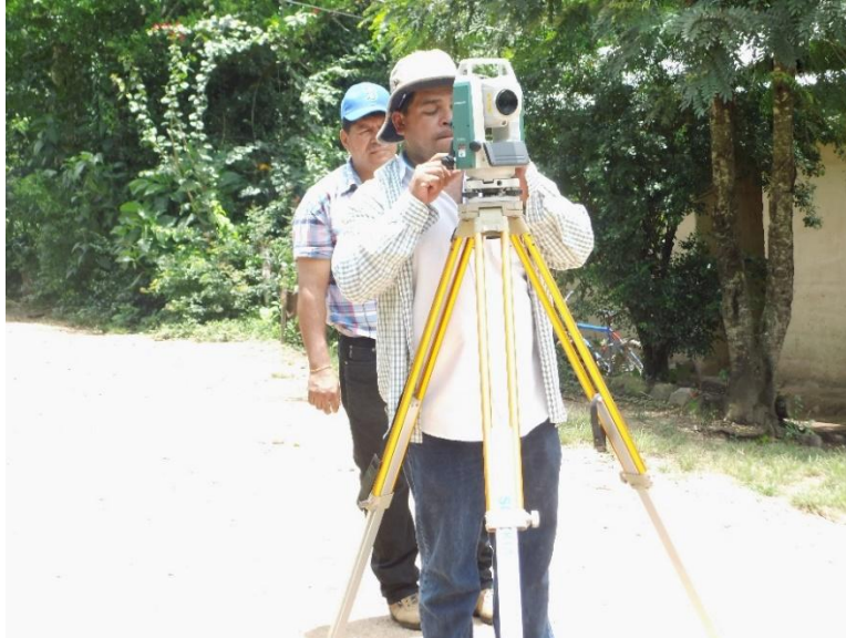
Imagen 4: Estación Total SOKKIA 6050RX y personal de levantamiento.
