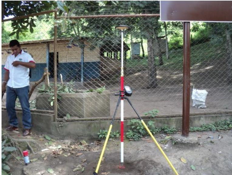
Imagen 6: Traslado de BM de inicio al sitio del proyecto.
