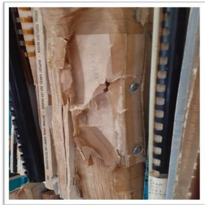
Fuente: Claudia Granera Muñoz – Cristina Hernández Suazo material bibliográfico con oxidación por objeto metálico (fastener), 2019
