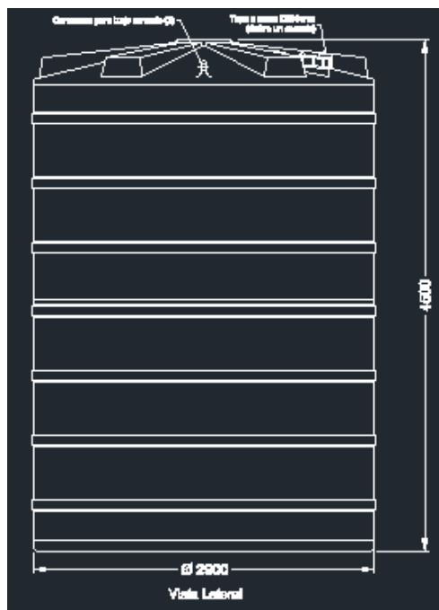
Figura 30: Dimensiones del tanque de dosificación.
