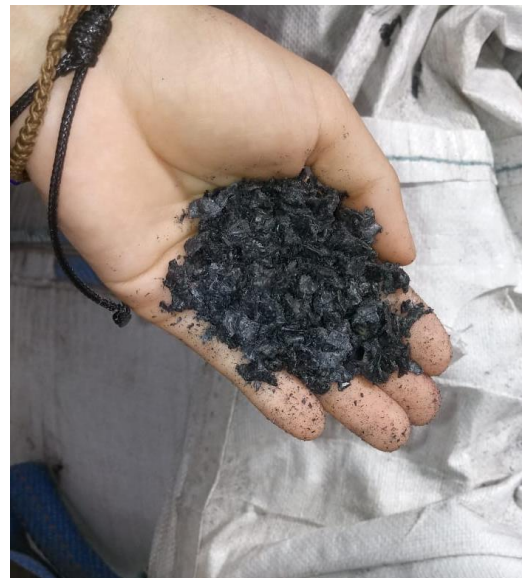
Fotografía VIII-3, PE-HD Colorado y triturado.
