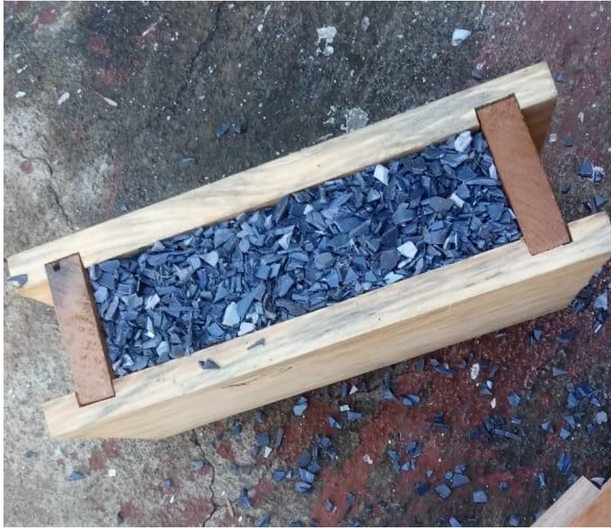
Fotografía XV-7, Molde de madera con plástico triturado
