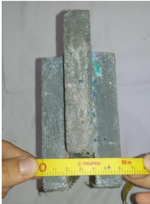
Fotografía XV-6, Verificación medidas bloque Código PP#6
