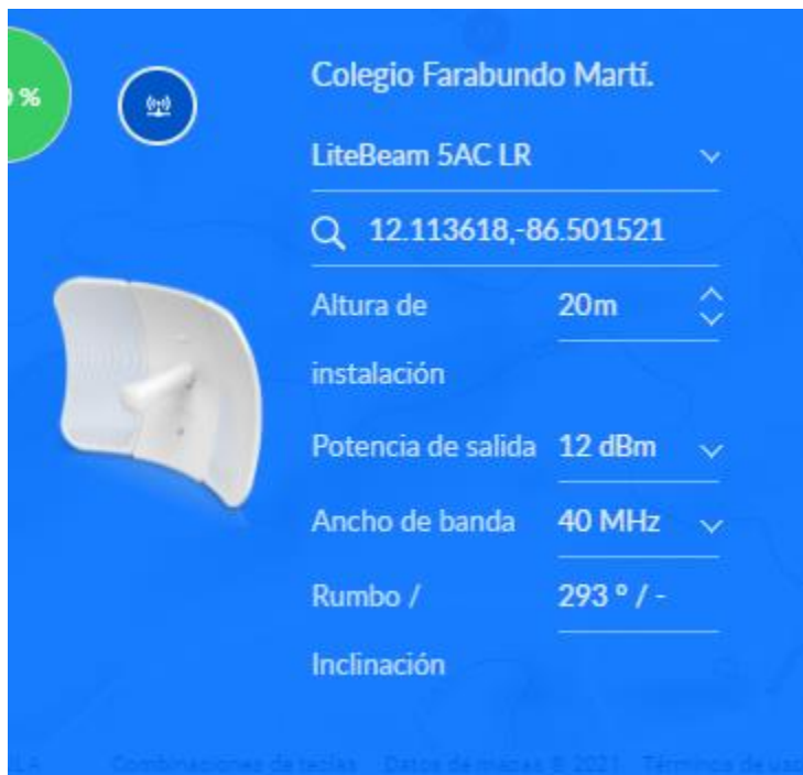
Imagen 34 Configuración del radio, en el colegio Farabundo Martí
