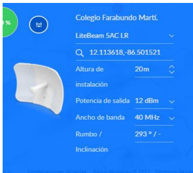
Imagen 30 Configuración del radio, en el colegio Farabundo Martí
