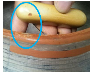
Obsérvese el desprendimiento de pigmentos al contacto con el pulidor. Fuente propia
