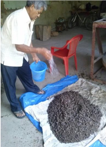
Humedeciendo el barro. Fuente propia.
