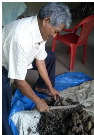
Don Gregorio Bracamonte en el proceso de picado del engobe. Fuente propia.
