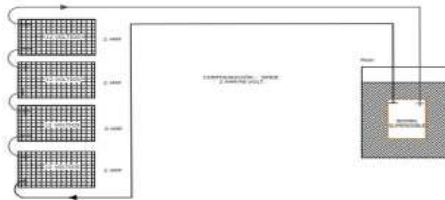
Ilustración 5 Conexión en serie (Maldonado y Jarquín, 20106)
