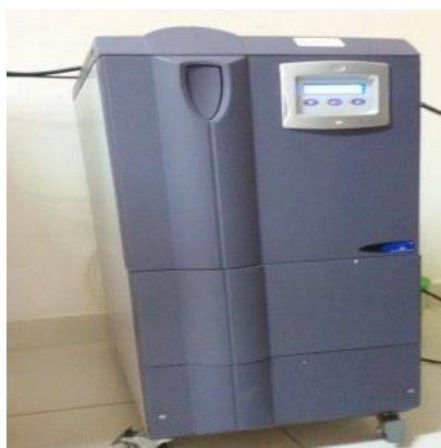
Figura 7. Generador de Nitrógeno, se utiliza para suministro conveniente y económico de nitrógeno de alta pureza para TLD de gas caliente. Adecuado para TLD Reader modelo RE-2000. Fuente: propia.
