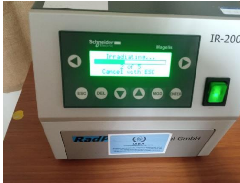
Figura 8. IR 200. 90 Sr Irradiador, se utiliza para la calibración de la sensibilidad del sistema para conocer la dosis local, para verificar la linealidad del sistema. Fuente: propia.
