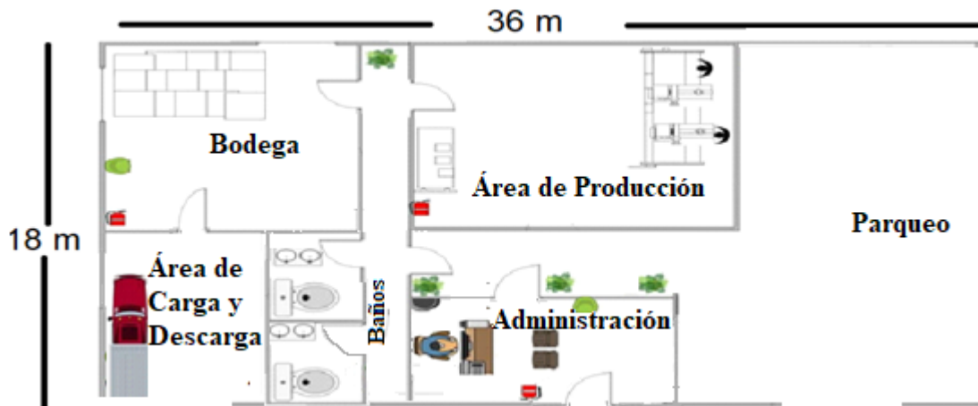
Ilustración 8 Distribución de la Planta
