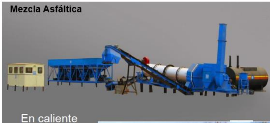
Gráfica 17. Fabricación Mezcla Asfáltica en Caliente
