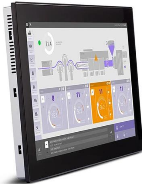
Figura 25. Imagen de Panel View ETOP-EPC1540TJ-S. Fuente: (Thomas Broadbent, 2017).
