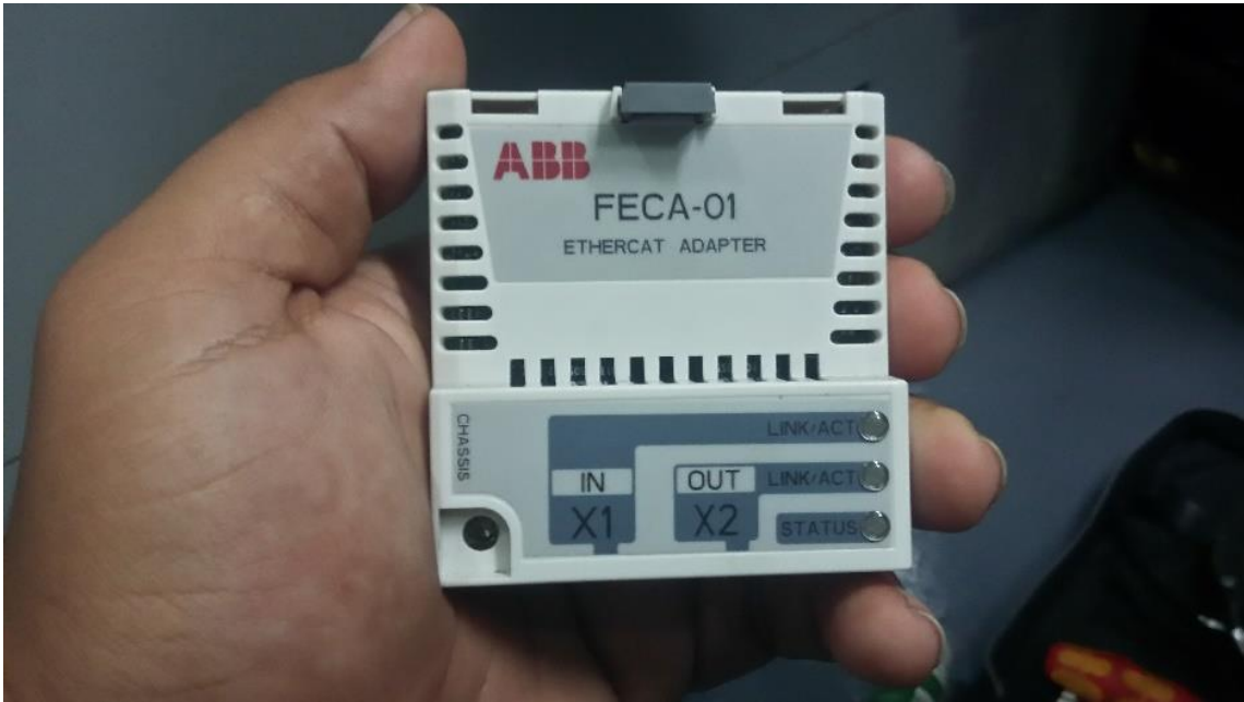
Figura 20. Fotografía del módulo retirado del VDF de la Centrífuga Fuente: Propia
