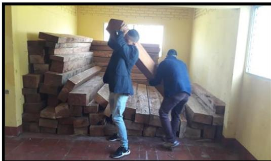
La materia prima es almacenada en una bodega, en el caso de la madera la que se va aserrando se saca al sol hasta que esté seca, se utiliza un termómetro llamado higrómetro para medir la humedad de la madera y asegurarse que este seca y lista para utilizarla, el plywood es almacenado en otra bodega, se almacena sobre una superficie plana y con buen nivel para evitar que se arquee.
