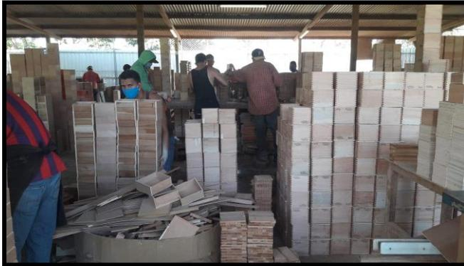
Consiste en unir las piezas laterales que conformarán la caja. En esta área reciben las piezas ya cortadas por el área de corte y alisado para armar la caja en donde se toma como referencia la cantidad de cajas que van a armar y así solicitar los materiales a utilizar:
