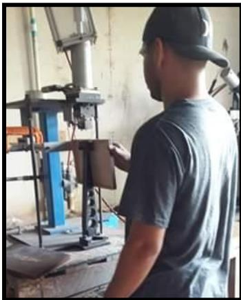
Este procedimiento consiste en colocar un broche, o dos según sea el caso, en la parte frontal de la caja, existen broches de punta y de clavo, los de clavo se colocan manualmente y los de punta se colocan con una maquina llamada embrochadora.
