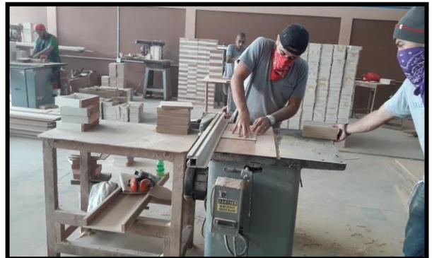
En el corte y alisado los trabajadores tienen que trabajar conforme a las medidas y cantidades establecidas que debe llevar cada caja, cabe mencionar que se elaboran diferentes tipos, algunas llevan más madera, plywood u otro material, y así conforme a esto el precio de venta va a variar, por eso se debe cumplir con todas las especificaciones en cuanto a cortes de la madera para evitar desperdicios innecesarios y la propia pérdida para la empresa.
