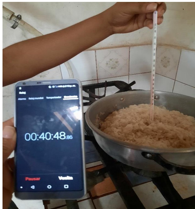
Figura 27: Prueba de controlado de cocinado con biogás
