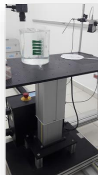
Figura 4.1 dosímetros irradiados en maniquí cilíndrico
