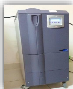
Figura 3.5 Generador de Nitrógeno
