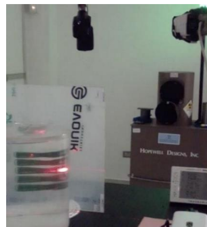
Figura 3.15: Montaje de irradiación de dosímetros con la fuente de referencia ^{137}\text{Cs} en el LCD del LAF-RAM.
