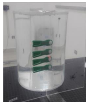
Figura 3.21 dosímetros de referencia irradiados a 0^\circ (posición normal)
