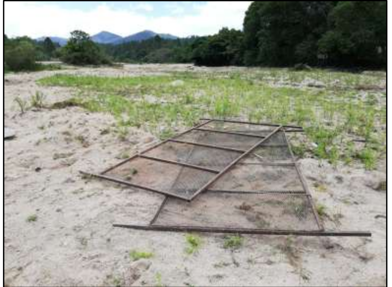
Imagen 4: Zarandas para colado de arena.
