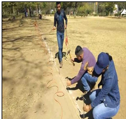
Figura 20. Mediciones de Tomografía Eléctrica en la Parte WE de los Campos del Recinto Universitario "Rubén Darío" UNAN-Managua.
