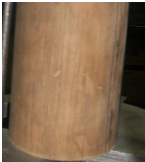
Figura 5.5 Imagen representativa de una muestra de espécimen que se utilizara para realizar la prueba de cortante con dimensiones; con una altura de 2 veces el diámetro.
