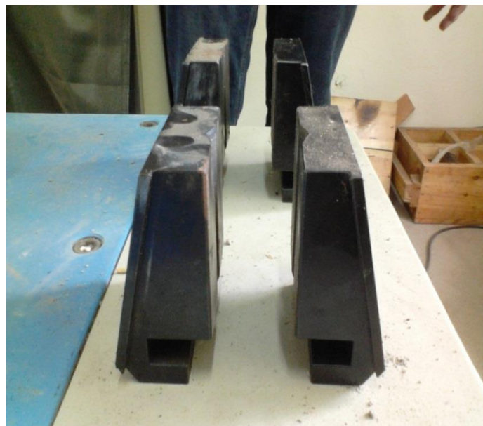
Figura A.7 Mordazas con ranura para varilla de media. Tomada de los laboratorios de ensaye a tracción perpendicular a la fibra.
