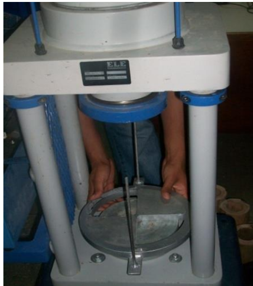
Figura 5.14 Colocación del dispositivo en la máquina de compresión. Laboratorio de la UNI
