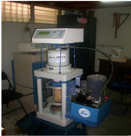
Figura A.9 Máquina utilizada para realizar los ensayos de compresión paralela a la fibra este equipo con capacidad máxima de carga de 600 KN se encuentra localizada en los laboratorios de ingeniería del recinto del RUPAP perteneciente a la UNI.
