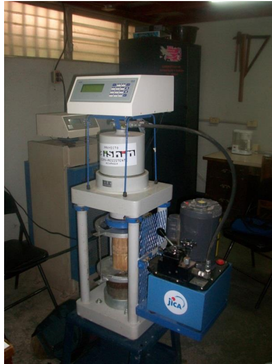
Figura A.8 Máquina utilizada para realizar los ensayos de compresión paralela a la fibra este equipo con capacidad máxima de carga de 600 KN se encuentra localizada en los laboratorios de ingeniería del recinto del RUPAP perteneciente a la UNI.
