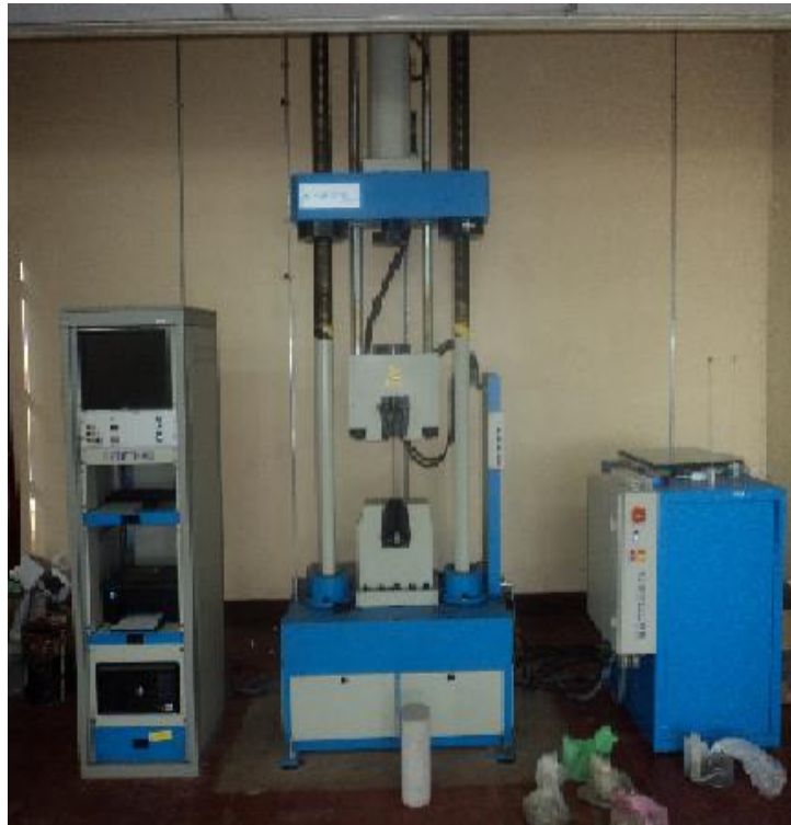
Figura 4.1 Máquina utilizada para realizar los ensayos de compresión paralela a la fibra este equipo de marca HOYTOM Leíoa modelo DI-CP/V2 con capacidad máxima de carga de 600 KN se encuentra localizada en los laboratorios de ingeniería del recinto de la UNAN-RURMA, perteneciente a la UNAN-MANAGUA.
