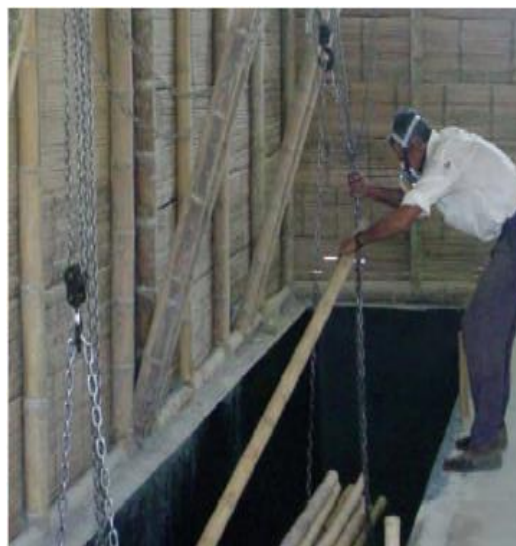
Figura 3.7 Manera en que se realiza el Curado por Inmersión. (Brigitte, C y Diego, M. (2004). Procedimiento de ensayo para la determinación de las propiedades físico mecánicas
