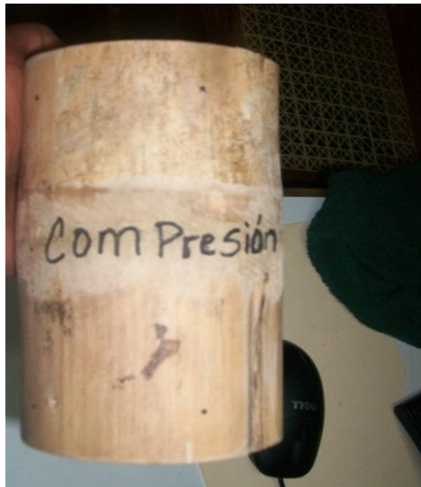
Figura 5.4 Imagen representativa de una muestra de espécimen que se utilizara para realizar la prueba a compresión, con dimensiones; altura 2 veces el diámetro.
