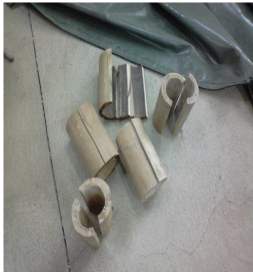
Figura 5.11 Muestras de algunas fallas al realizar ensayo tracción perpendicular a la fibra.
