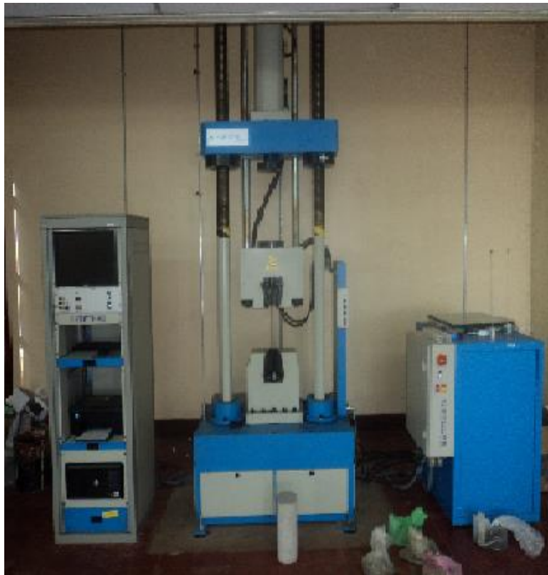
Figura A.1 Máquina utilizada para realizar los ensayos de compresión paralela a la fibra este equipo de marca HOYTOM Leíoa modelo DI-CP/V2 con capacidad máxima de carga de 600 KN se encuentra localizada en los laboratorios de ingeniería del recinto de la UNAN-RURMA, perteneciente a la UNAN-MANAGUA.
