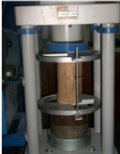
Figura 4.4 Esquema de representación de aplicación de la carga axial en la probeta de bambú Amplexifolia en el ensayo a cortante perpendicular a la fibra. Por medio de los dispositivos.
