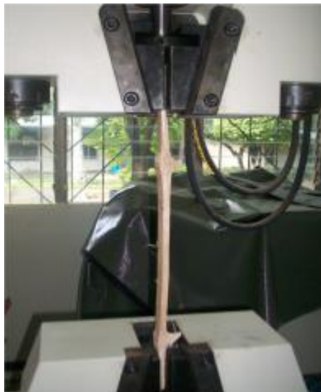
Figura 5.2 Imagen representativa de una muestra de espécimen que se utilizara para realizar la prueba a tracción paralela a la fibra., con dimensiones; con una longitud de 50 cm.
