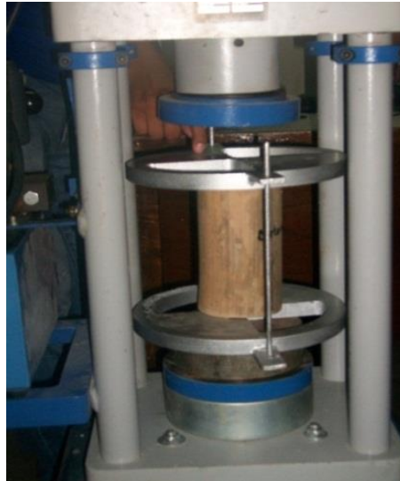
Figura 5.15 Ubicación del dispositivo de cortante para ejercer la carga axial de cortante con la ayuda de la máquina de compresión. Laboratorio de la UNI.
