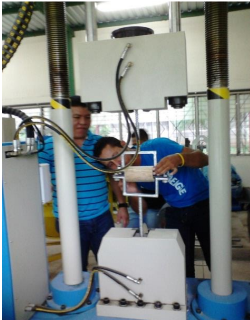
Figura 5.10 a) Ensaye a tracción perpendicular a la fibra, b) montaje y aplicación de carga axial. Laboratorio de la UCA.
