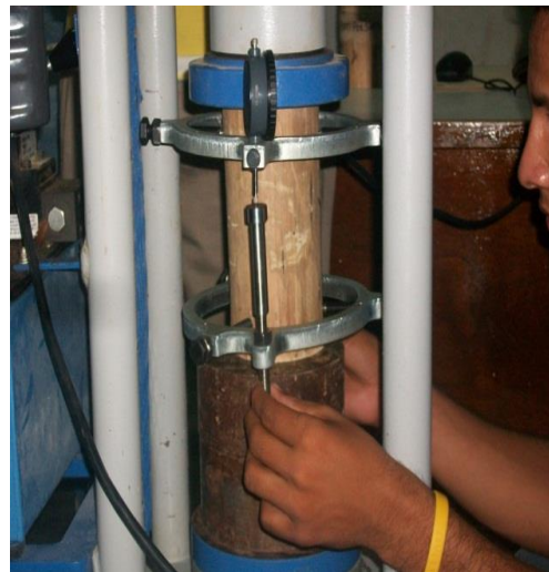
Figura 5.13 a) Colocación del espécimen en la máquina de compresión. b) Calibración de los deformímetros para tomar lecturas. Laboratorio de la UNI.
