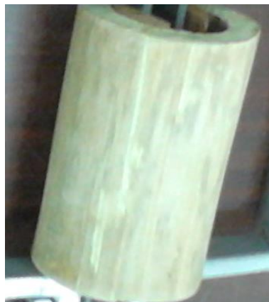
Figura 5.3 Imagen representativa de una muestra de espécimen que se utilizara para realizar la prueba a tracción perpendicular a la fibra, con dimensiones; altura de 10 a 15 cm.
