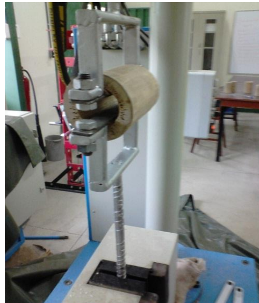
Figura 5.10 a) Ensaye a tracción perpendicular a la fibra, b) montaje y aplicación de carga axial. Laboratorio de la UCA.
