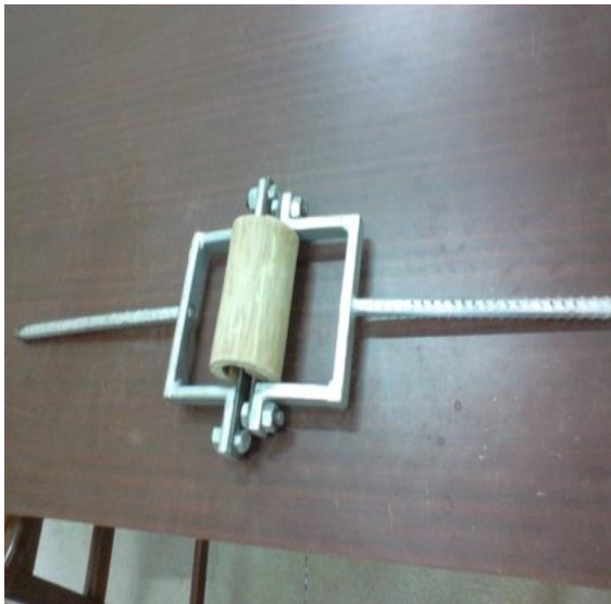
Figura 5.9 a). Colocación del espécimen de Guadua Amplexifolia en el dispositivo de ensaye. b). Montaje de las mordazas planas para realizar ensaye de tracción perpendicular a la fibra. Laboratorio de la UCA.
