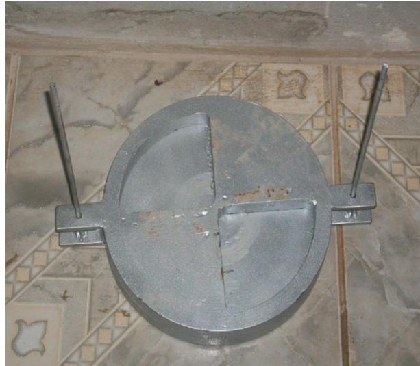
Figura A.11 Dispositivo de ensaye para determinar el cortante paralelo a la fibra con una vista en 3D.
