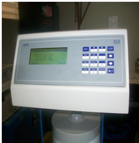
Figura 5.16 a) Pantalla que registra la carga aplicada para provocar cortante. b) Muestras de las fallas en el ensaye de cortante.
