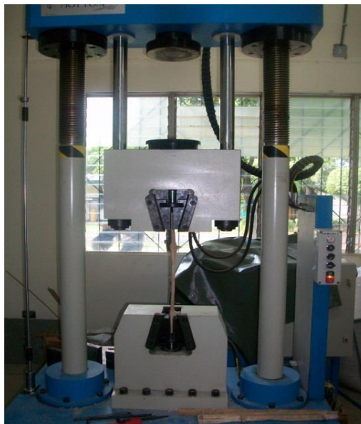
Figura 5.8 Ensayo de tensión o tracción perpendicular a la fibra. Se presentó fallas en el centro de las láminas. Laboratorio de la UCA.
