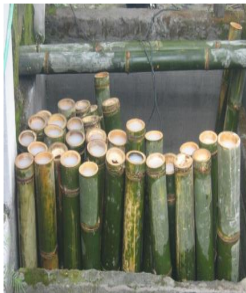
Figura 3.9 Especímenes de bambú sumergidos en bórax con cipermetrina, curado con ácido bórax y cipermetrina (Brigitte, C y Diego, M. (2004). Procedimiento de ensayo para la determinación de las propiedades físico mecánicas de la Guadua).
