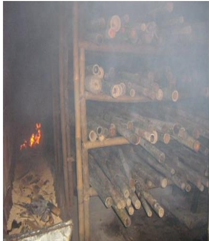
Figura 3.6 Elementos de bambú durante el proceso de curado al humo. (Brigitte, C y Diego, M. (2004). Procedimiento de ensayo para la determinación de las propiedades físico mecánicas de la Guadua ).
