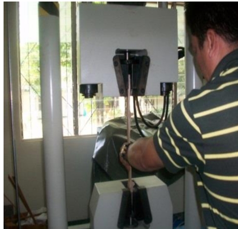
Figura 5.7 Montaje de láminas de bambú Guadua Amplexifolia ensaye tracción perpendicular a la fibra. Laboratorio de la UCA.
