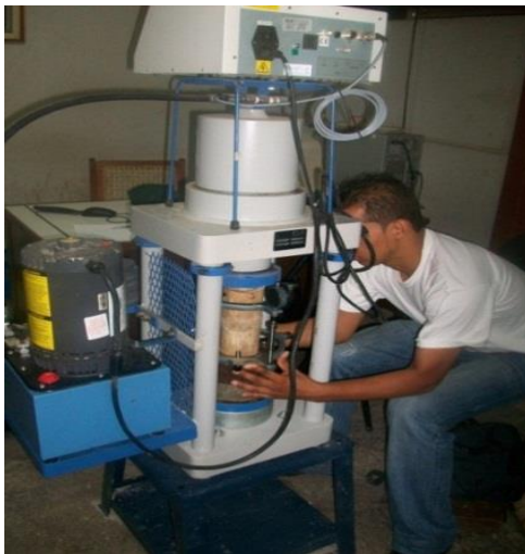
Figura 5.13 a) Colocación del espécimen en la máquina de compresión. b) Calibración de los deformímetros para tomar lecturas. Laboratorio de la UNI.
