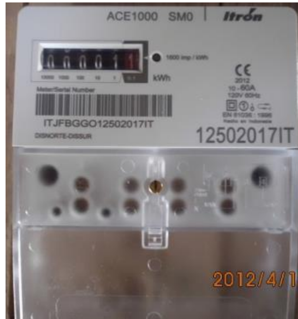
Figura 8: Medidor estático o electrónico
