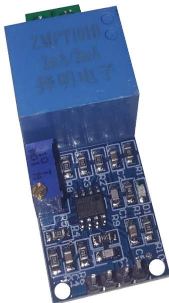
Figura 28. Sensor de voltaje ZMPT101B
