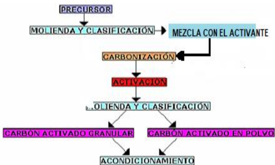
Figura 2.4 Diagrama de los procesos que llevan a cabo la activación térmica.
