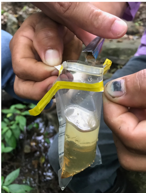
Figura 10. Prueba de coliformes fecales en fuente de agua. Fuente: Fotografía tomada por investigadores.
