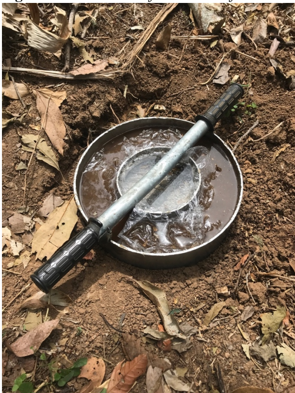
Figura 9. Prueba de infiltración en finca Ebenezer.
