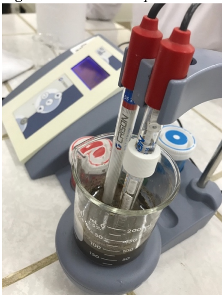
Figura 10. Análisis de pH de suelo en Laboratorio.
