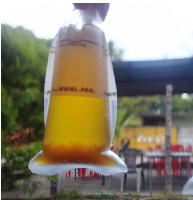
Figura 11. Resultado negativo de bacterias productoras de H_2S en fuente de agua en finca Ebenezer. Fuente: Fotografía tomada por investigadores.
