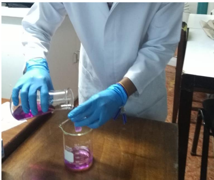
Figura 25. Pruebas de laboratorio en la remoción de cromo hexavalente utilizando cáscara de plátano
