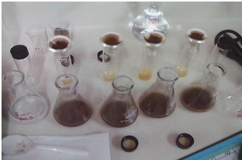
Figura 19. Pruebas de laboratorio en la remoción de cromo hexavalente utilizando cáscara de plátano.- Laboratorio de Biotecnología
