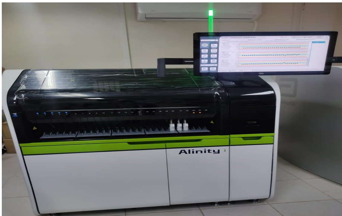
Figura 6: Fotos del equipo Alinity que se utiliza para la determinación de agentes infecciosos (VIH, Sífilis, Hepatitis B, hepatitis C) mediante quimioluminiscencia.
