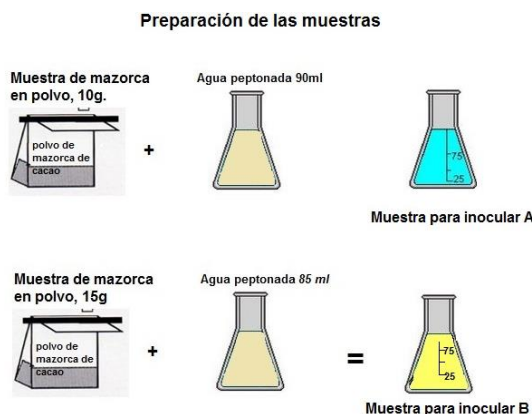
Figura 3.6.1. Preparaciones de las muestras A y B para todas las pruebas microbiológicas.
