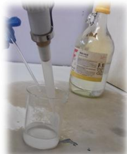
Figura 9. 1. Solución buffer con acetato de amonio, EDTA, agua HPLC y ácido acético.
