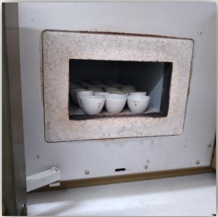
Figura 5. 1. Se toma 1 g de la muestra seca para proceder a calcinar a 500°C
