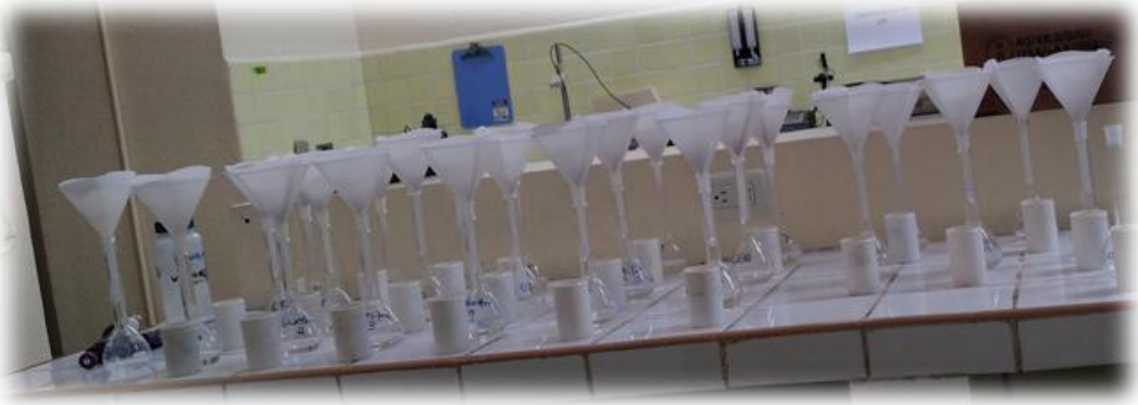
Figura 9. 5. Se filtró el contenido del crisol a través de un papel de filtro, recibiendo el filtrado en un matraz volumétrico de 100 mL
