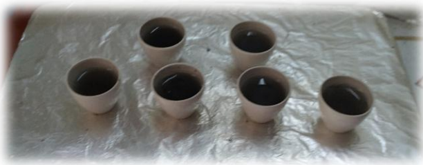
Figura 9. 3. Se agregaron 10 mL de ácido clorhídrico a 2 M en los crisoles que contiene las cenizas.
