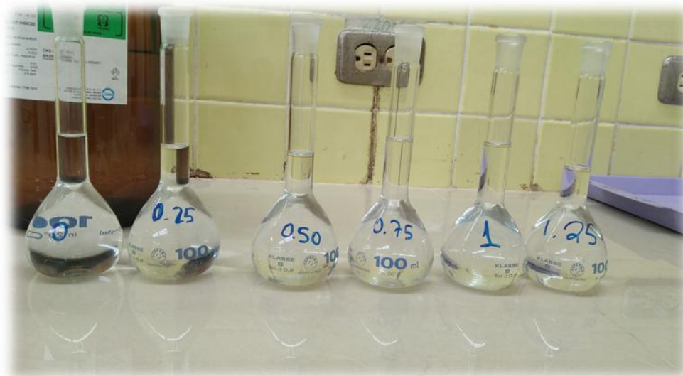
Figura 9. 6. Se prepararon 6 estándares, en el que se miden alícuotas de la solución estándar de trabajo de B 10 ppm según la tabla 3.5 se transfieren a matraces volumétricos clase A de 100 mL y se almacenaron en un frasco de polietileno
