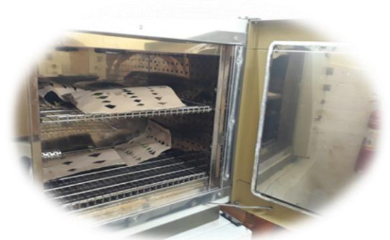
Figura 3. 4. Secado de la muestra en el horno a 60°.
