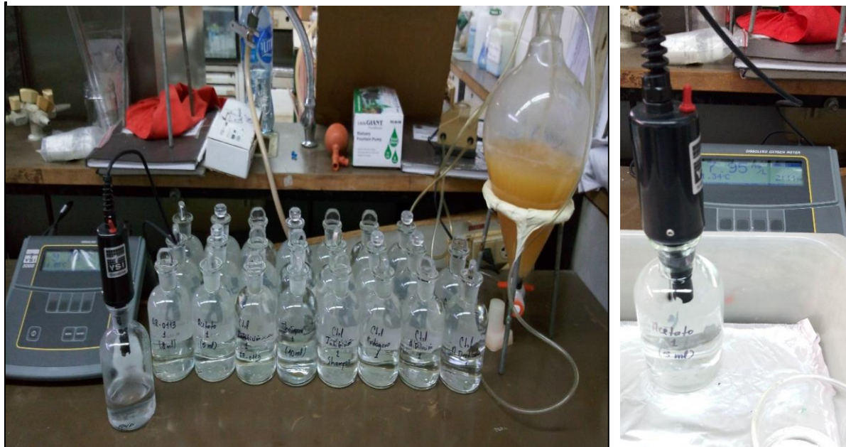
Figura 25. Primer lectura del OD para la estimación de la biodegradabilidad.
