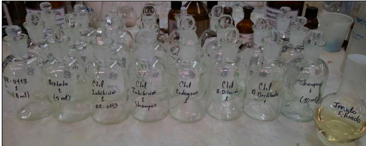
Figura 24IV. Preparación de las botellas Winkler para el montaje del ensayo de biodegradabilidad.
