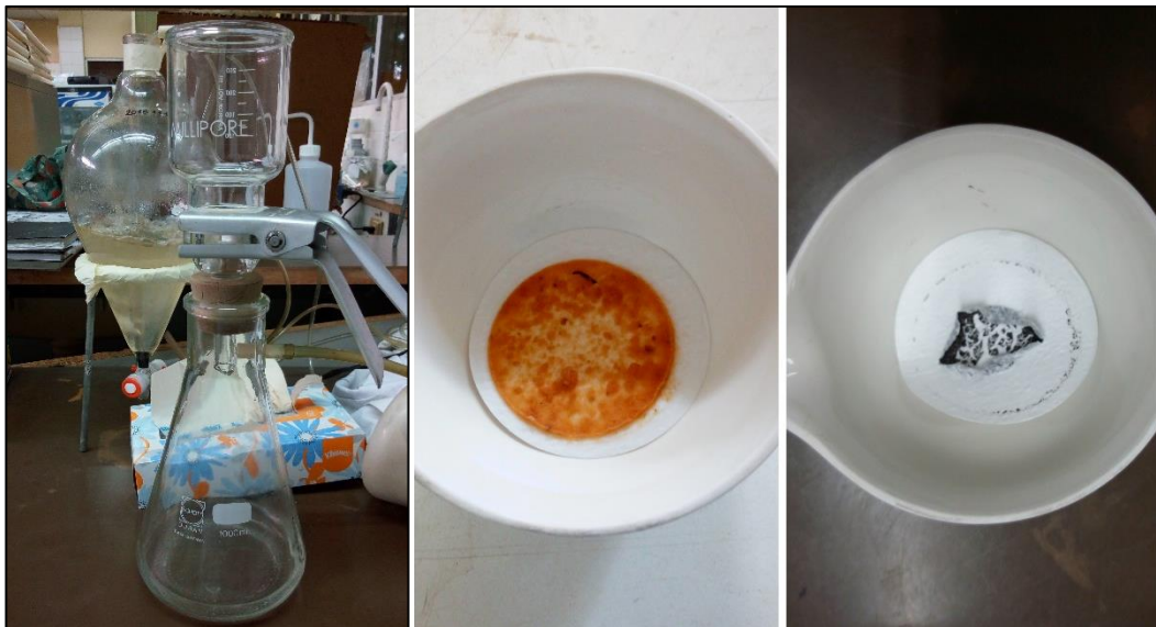
Figura 19. Análisis de SSV para determinar la madurez del inóculo.
